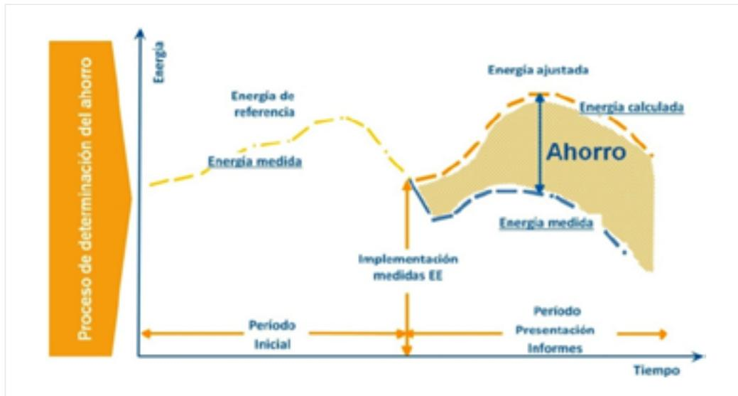
Figura.32. Fases generales en la ejecución de un Plan de Medida y Verificación de ahorros energéticos (Fuente: adaptación de IPMVP Volumen 1, 2010).
